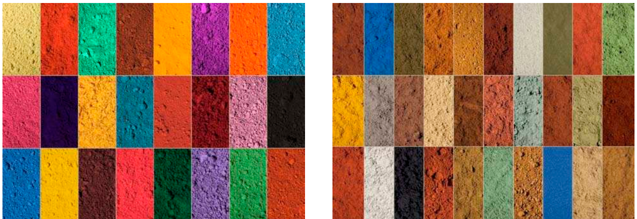
Fotos von Felix Kraemer, Copyright kt.COLOR 2010. Links synthetisch hergestellte, rechts natürliche anorganische Pigmente.
